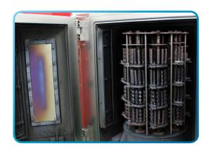
我們工廠有來自德國高品質的奈米塗層設備, 使刀片具有極高的抗氧化性和耐熱性。專為乾、 濕和高速加工應用而設計。
