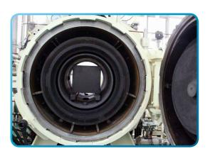
萬事達工廠有先進的高溫加壓燒結工藝,可消 除刀片氣孔及提升材質穩定性。
