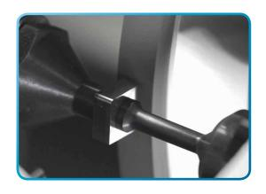
高精度瑞士 CNC 磨床確保研磨公差。可以實 現高精度不同輪廓的刀片表面品質。
